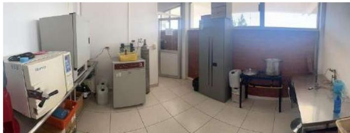
Área de siembra y preparación de medios de cultivo: En esta área se cuenta con mesas de trabajo con mecheros, autoclaves, incubadora fija a 37°C y una estufa con tanque de CO<sub>2</sub>.
