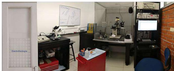
Cuarto de electrofisiología; que cuenta con un set up de electrofisiología sobre una mesa antivibratoria acoplada a un tanque con nitrógeno líquido, que incluye microscopio invertido, sistema de micromanipulación, sistema de perfusión, digitalizador, amplificador y computadora, además de contar con un estirador (puller) y una microforja, para la obtención de microelectrodos etc.
